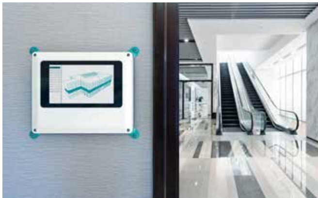
(© zhu_difeng@shutterstock/Phoenix Contact) Applikationseksempel med bygningsautomation: touch display og single-board computer i et individuelt tilpasset hus til vægmontering
